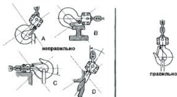
Рис. 4 Правильная и неправильная фиксация крюков
